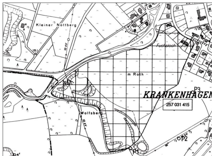
Abb. 2: Altablagerungen in ehem. Boden- und Bauschuttdeponie Kuhlmann (schwarze Schraffur), aus: Geonova GmbH (1992): Altlastenprogramm des Landes Niedersachsen. Gezielte Nachermittlungen - Ausschnitt aus GK 1:5000; Blatt 3820/14.
