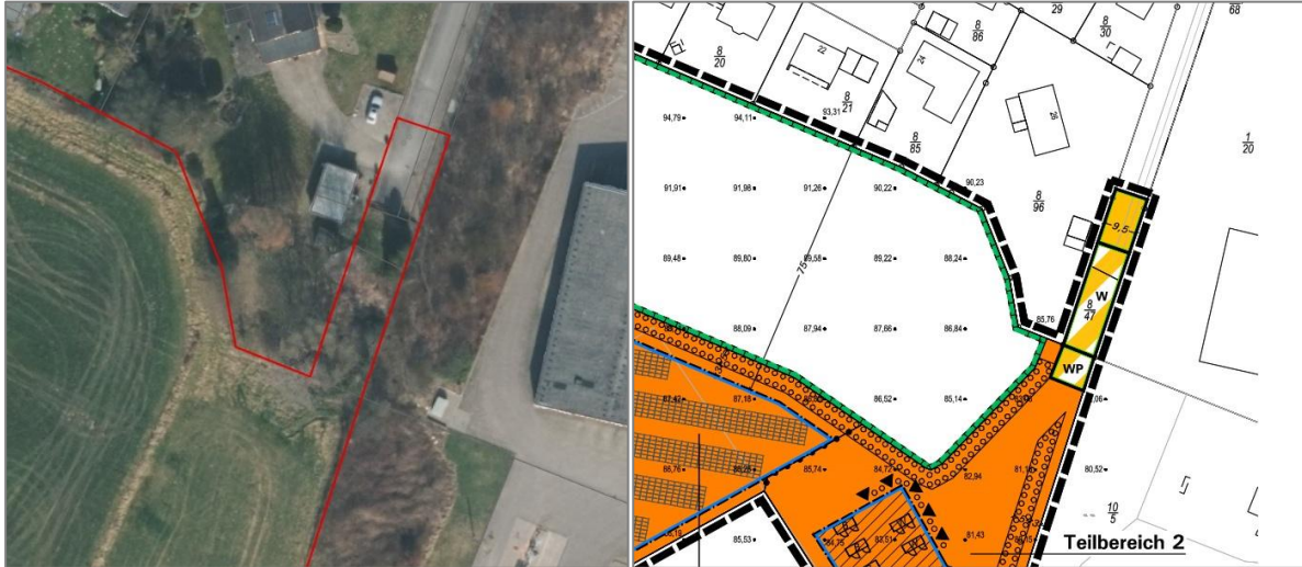
Abb. 5-3: Kleinflächige Erweiterung des Geltungsbereichs zur Sicherstellung der Anbindung der bereits betrachteten Fläche für eine FF-PV-Anlage, links Bestand im Bereich der Erweiterung des Geltungsbereichs anhand des aktuellen Luftbildes, rechts Ausschnitt B-Plan mit geplanten Festsetzungen als Wegeflächen (Tischmann Loh & Partner 2026); genordet, unmaßstäblich
